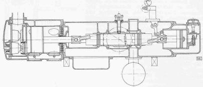
Abb. 1. Pescara-Flugkolben-Kompressor P-13 im Längsschnitt. — Masstab 1:20
