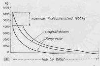
Abb. 4. Diagramme von Kompressor und Ausgleichkissen im Kräftemasstab
