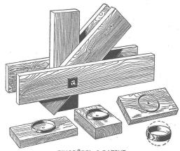
RINGDÜBEL ☆ PATENT Knotenpunktverbindung für hölzerne Tragwerk
