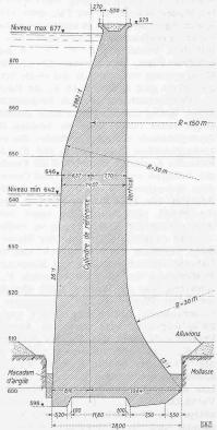
Abb. 3. Querschnitt 1 der Staumauer Rossens. - 1:800
