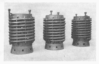
Abb. 1. Kühlschlangen. Rohr aus bildsamer Siliziummasse, auf den Träger aufgewunden und mit diesem zusammen gebrannt
