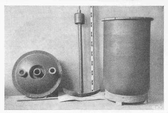
Abb. 2. Kessel mit Rührer und Deckel aus wärmeleitendem keramischem Siliziummaterial
