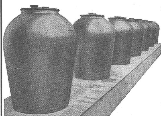
Gefässe, Apparate, Rohrleitungen, Auskleidungen aus säurefesten,
