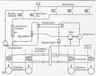
Schema der Abluft-Wärmepumpanlage Altendorf des Etzelwerkes
