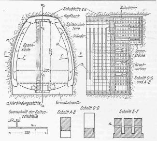
Elemente und Zusammenbau des Systems Ripplinger-Berg. 1:50
