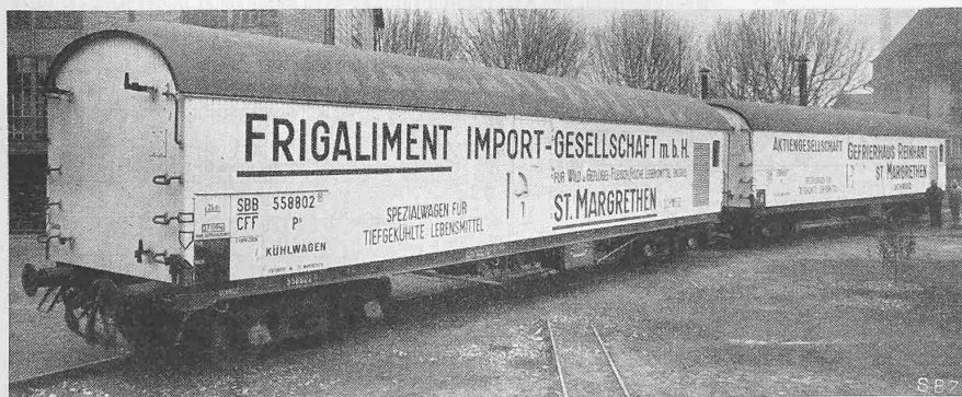
Abb. 1. Grossraum-Tiefkühlwaggons, gebaut von Escher Wyss A. G., Zürich, in Verbindung mit der Schweizerischen Industrie-Gesellschaft, Neuhausen
