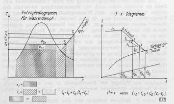
Abb. 15. Zur Theorie des Trockenvorganges
