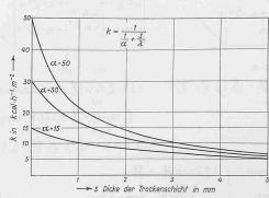
Abb. 16. Wärmedurchgangszahlen in Abhängigkeit der Dicke der Trockenschicht
