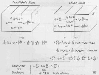
Abb. 14. Feuchtigkeits- und Wärmebilanz für ein Garnkörperelement
