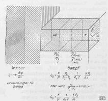
Abb. 13. Bewegung des Dampfes durch ein Garnkörperelement
