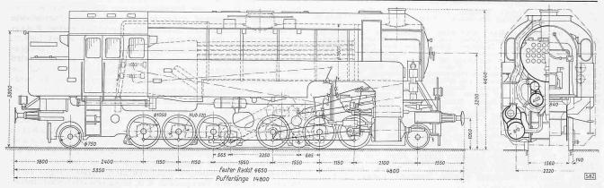
Abb. 1. Normalspurige Adhäsions- und Zahnrad-Tenderlokomotive der Wiener Lokomotivfabrik Floridsdorf. - Typenskizze 1:100
