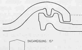
Abb. 11. Ludowici-Flachpfannendach. Die überdeckte, hochgestellte Fuge bleibt bis zu einem starken Rückschwall-Wasserstand trocken
