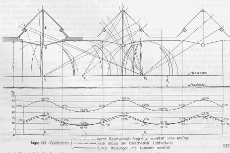
Abb. 2. Vergleich der berechneten und der gemessenen Tageslichtquotienten
