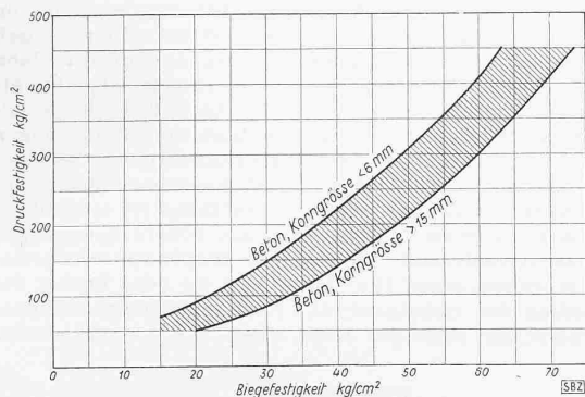
Abb. 4. Druckfestigkeit von Betonwürfeln 16 cm in Funktion der Biegefestigkeit von Mörtelprismen 2 \times 2 \times 12 cm
