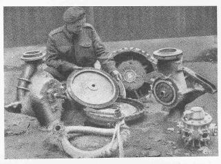
Abb. 8. Demontiertes Aggregat; das Turbinenlaufrad und die Segmente des Leitrades sind sichtbar. Im Vordergrund die mit Glaswolle isolierte Turbinenleitung und ein Sauerstoffverteiler
