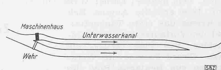
Abb. 3 Maschinenhaus bei der Wasserentnahme, Oberwasserkanal sehr kurz. (Kraftwerk Rapperswil-Auenstein)
