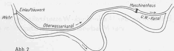
Abb. 2 Maschinenhaus zwischen Ober- und Unterwasserkanal (Kraftwerke Olten-Gösgen und Hagneck)
