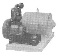
starten mit der erzeugten Druckluft jeden Diesel-Motor
