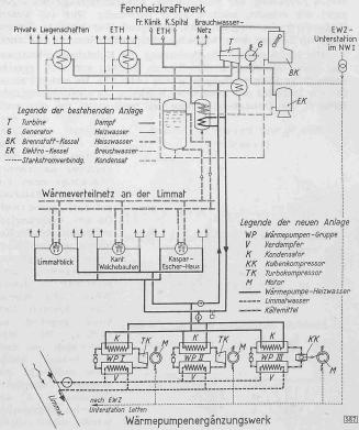
Abb. 1. Schema der Kupplung von FHK und Ergänzungswerk
