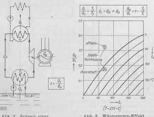
Abb. 2. Schema einer Wärmepumpanlage
