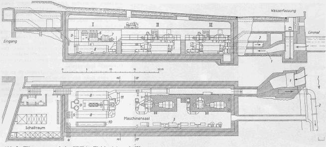
Abb. 5. Wärmepumpwerk des FHK im Walcheplatz. I Wärnepumpensatz mit Kolbenverdichter Gebr. Sulzer, II, III Brown Boveri Thermoblocs. — 1 Wasserzulauf, 2 Wasserablauf, 3 Umwäizpumpen für Heizwasser, 4 Heizwasser Vorlauf, 5 Heizwasser Rücklauf, 6 Kolbenverdichter, 7 Antriebmotor, 8 Röhrenkessel-Verdampfer, 9 Gaskühler, 10 Röhrenkessel-Kondensator, 11 Limmatwasser-
