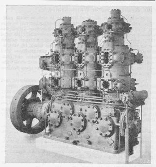
Abb. 9. Sulzer-Kolbenverdichter, 46 atu, 500 U/min
