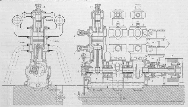
Abb. 10. Dreistufiger Kolbenverdichter Sulzer, 1:30. — 1 Oelgesteuerte Saugventile der 1. Stufe, 2 Oelgesteuerte Saugventile der 2. Stufe, 3 Oelgesteuerte Saugventile der 3. Stufe, 4 Steuerapparat, 5 Zahnradölpumpe für Lagerschmierung, 6 Oelfilter, 7 Oelkühler, 8 Metallische Stopfbüchse, 9 Motorkupplung, 10 Zylinder-Schmierpumpen
