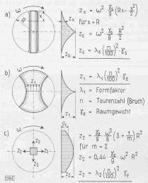
Abb. 18. Messung der Zerreissfestigkeit  $z_1$  durch Rotation des Probekörpers (Schema)
