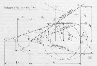
Abb. 20. Vollständiges Scherdiagramm kohärenter Lockergesteine
