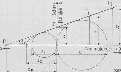
Abb. 17. Schema zur Bestimmung d. Kohäsion c
