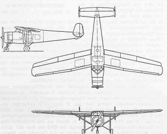
Abb. 1. Typenskizze 1:200 des Pilatus-Pelican «SB2»
