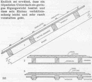
Abb. 8. Feuersicheres Gipsdielen-Unterdach
