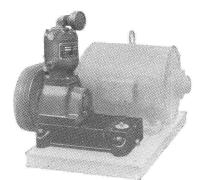
starten mit der erzeugten Druckluft jeden Diesel-Motor
