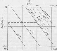
Abb. 8. Beziehung reduzierter Saugkraft und Saughöhe bei verschiedener Durchlässigkeit und gegebener Kältedauer
