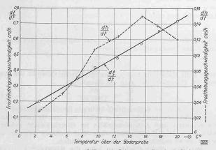
Abb. 4. Frosthebungs- und Frosteindringungs-Geschwindigkeit in Funktion der Gefriertemperatur bei einem Mo-Sand (gezeichnet nach Versuchen von Dücker)
