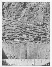
Abb. 1. Vertikalschnitt durch eine Bodenprobe nach Beendigung des Gefrierversuchs. Gut entwickelte Eislinien. (Phot. Lab. de géotechnique de l'Ecole d'Ingénieurs de Lausanne)
