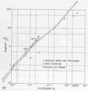
Abb. 6. Bestimmung der Saugkraft  $\frac{P_s}{\gamma_w}$  (in Zentimetern) nach Versuchen von Dücker nach Versuchen von Dücker
