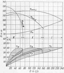
Abb. 9. Kennlinien dreier verschiedener, in ihren zugeordneten Bereichen einzeln arbeitenden Pumpen Typ I, II und III.  $H_{\mathrm{mano}}$  I und  $\eta_{\mathrm{I}}$  der Pumpe I  $H_{\mathrm{mano}}$  II u.  $\eta_{\mathrm{II}}$ : Pumpe II;  $H_{\mathrm{mano}}$  II u.  $\eta_{\mathrm{II}}$  P III
