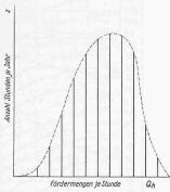
Abb. 2. Häufigkeitskurve einer Zentrifugalpumpenanlage. Jährliche Betriebstunden, während
