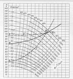
Abb. 5. Muscheldiagramm einer Zentrifugalpumpe (Abszissenwerte Q, Ordinatenwerte H). Legende: 1, 2, 3 Rohrkennlinien; a,b,c Leerlaufpunkte; B Betriebspunkt
