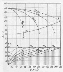
Abb. 8. Kennlinien von vier parallel arbeit. Zentrifugalpumpen gleicher Grösse Typ III. 1 eine Pumpe allein, Wirkungsgradkurve  $\eta_1$ , 2 zwei Pumpen parallel, desgl.  $\eta_2$ , 3,  $\eta_3$  drei Pumpen; 4,  $\eta_4$  vier Pumpen parallel
