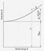
Abb. 1. Kennlinie einer Rohr-Leitung. — B Betriebspunkt
