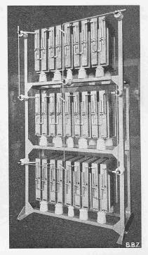
Abb. 3. Nepolin-Kondensatorenbatterie der Micafil A.-G. Zürich-Altstetten
