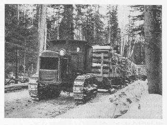
Abb. 5. Raupenschlepper mit Schlitten für Papierholztransport (U.S.A.)
