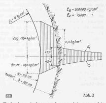
dies im Wasserbau zu Bedenken Anlass und man ist versucht, diese Zugspannungen mittels einer Armierung herabzusetzen. Vorerst soll jedoch noch gezeigt werden, welche Werte die uns am meisten interessierenden tangentialen Zugspannungen
