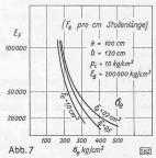
Es gehen aus den Diagrammen folgende zwei Tatsachen mit aller wünschbaren Deutlichkeit hervor: Die Armierung kann bei weitem nicht ausgenützt werden. Als zweites muss festgestellt werden, dass die tangentiale Zugspannung im Beton durch die Armierung ganz unwesentlich vermindert wird, sodass trotz der Bewehrung mit dem Reissen des Betons gerechnet werden muss.
