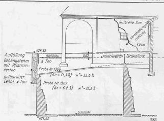
Abb. 11. Baugrunduntersuchung mittels Rammprofilen bei einem durch ungleichmässige Setzungen und Rissbildungen beschädigten Gebäude. Aufnahme durch Ing. Münger und Dr. Knecht, Geolog
