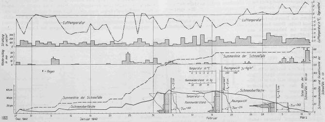
Abb. 9a. Zeitprofil der Schneedecke von Zürich (neben der Versuchsanstalt für Wasserbau) für die Zeit vom 27. Dez. 1941 bis 12. März 1942
