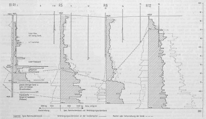
Abb. 14a. Rammprofile, aufgenommen durch Ing. Münger und Dr. Knecht, Geolog Sondendurchmesser 33 mm, Gewicht der Rammbären 60 kg, Fallhöhe 50 cm
