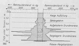
Abb. 12. Baugrunduntersuchung mittels Rammprofilen. Unterscheidung von aufgelockerter und festgelagerter Grundmoräne. Aufnahme durch Ing. Minger u. Dr. Knecht
