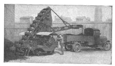
Die Einschaltung zuverlässig arbeitender Gurtförderer ,RACO', auf Raupenbänder laufender Becherwerksauflader oder anderer Fördergeräte, die wir als Spezialität liefern, vermag bei Steigerung der Leistungsfähigkeit die Transportkosten bedeutend zu reduzieren.
