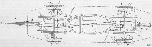
Abb. 3. Chassis-Konstruktion (Grundriss) mit Lenkmechanismus (Legende im Text)
