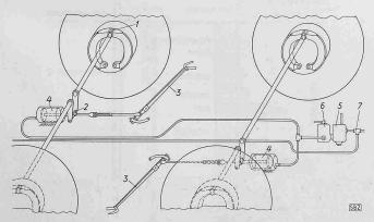
Abb. 7. Bremssystem für Vierrad-Anhänger Legende: 1 Bremsbacken, 2 Bremsausgleich, 3 Handbremshebel, 4 Pneumatischer Bremszylinder, 5 Steuerventil, 6 Einstellbarer Bremsdruckminderer, 7 Doppelrückschlagventil
