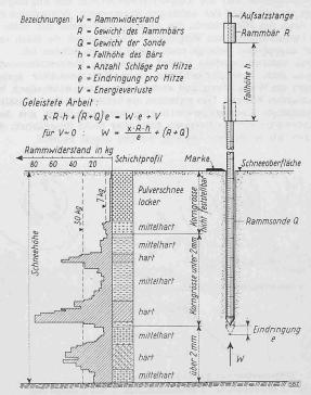
Abb. 8. Rammwiderstand und Rammprofilaufnahme in der Schneedecke
