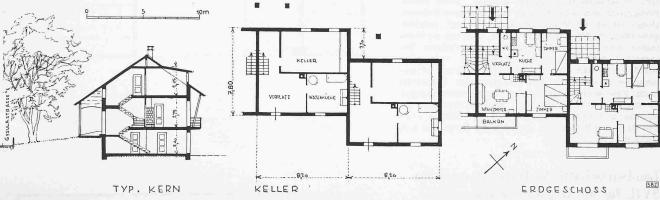
Abb. 7 bis 9. Schnitt und Grundrisse 1:300 vom Haustyp «Kern»
