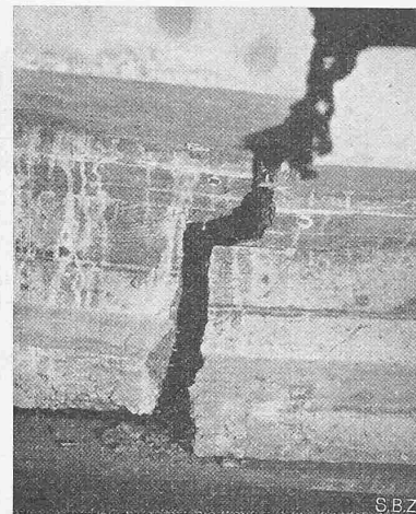
Abb. 23. Bruchstelle des Balkens Zerstörung durch Zerreißen der Stahldrähte
