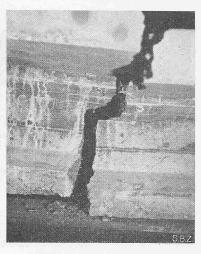
Abb. 23. Bruchstelle des Balkens Zerstörung durch Zerreissen der Stahldrähte
