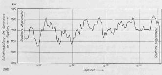
Ausschnitt aus einem Belastungsdiagramm der Escher Wyss-Werke bei ausschliesslichem Betrieb durch die Versuchsanlage
