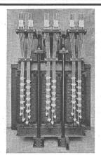
Drehstromtransformator mit Aluminiumgehäuse 3200 KVA 15 000/230 Volt 50 Per. 127/8250 Amp.
