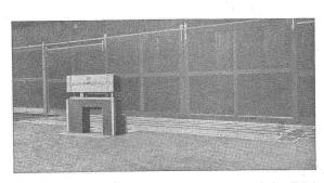
40 t Geleisewaage mit armierter Betonbrücke, torsionsfreien Hebeln und verstellbaren Schneiden.
