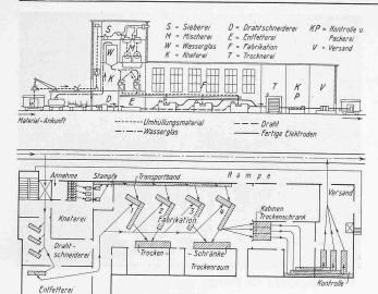
deren grosszügige und vorteilhafte Planung besonders günstigen Umständen zu danken ist, kann die Elektrodenfabrik der Werkzeugmaschinenfabrik Oerlikon, Bührle & Co. erwähnt werden (Abb. 1); die Firma hatte Gelegenheit, für ihre Neuanlage drei Jahre lang in behelfsmässigem Fabrikbetrieb Erfahrungen zu sammeln. Für die ausgesprochene Massenfertigung von Schweiss-Elektroden spricht die grosse Kapazität von 2 bis 3 Millionen Stück, die das Werk monatlich herzustellen vermag.
