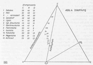
(Dehydrierung — Oxydation) bedeutet. Das besonders Seltsame ist, dass man eine ganz ähnliche Kurve bekommt, wenn man im CHO-Dreieck die Zusammensetzung der Stoffe einträgt, die bei der Holzverkohlung im Laufe des Vorgangs folgeweise entstehen (also feuchtes Holz, trockenes Holz, Rotkohle, Retortenkohle, Meilerkohle). Der rasche Vorgang der Holzverkohlung ähnelt also überraschend weitgehend dem sehr langsamen Inkohlungsvorgang der Natur.
