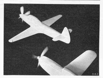
Abb. 1. Heutige (unten) und künftige (oben) Flugzeugform ; diese ermöglicht durch Landebremsung ohne Mehrleistung gegen 1000 km/h
