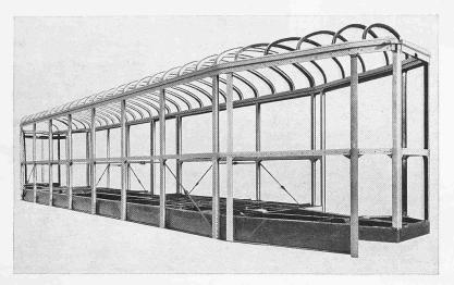
Abb. 8. Kastengerippe der neuen Vierachser Strassenbahnwagen der Schweiz. Wagons- und Aufzügefabrik in Schlieren
