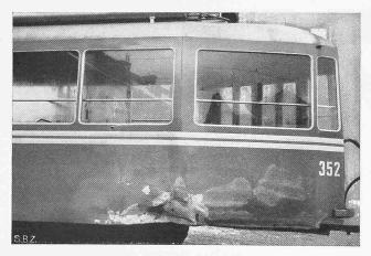
Abb. 3. Metallwagen nach seitlichem Zusammenstoss
