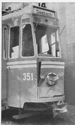
Abb. 1. Stahlschalenbauart nach Zusammenstoss unter ähnlichen Verhältnissen
