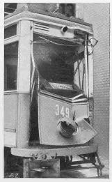
Abb. 1. Stahlschalenbauart Abb. 2. Holzgerippe-Wagen nach Zusammenstoss unter ähnlichen Verhältnissen
