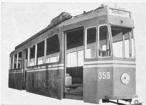
Abb. 6. Seitenwand rechts mit Eindrücken unten und oben vorn
