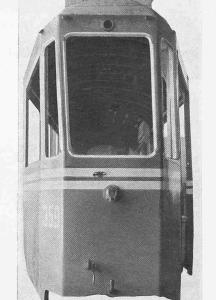
Abb. 7 (rechts). Rückansicht Nr. 359, oberer Wagenteil leicht nach links gedrückt
