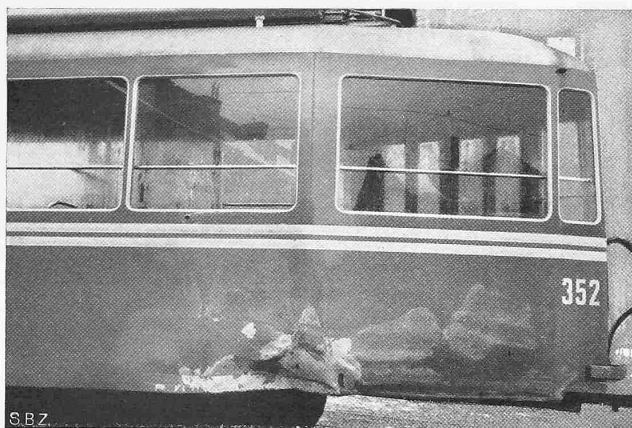
Abb. 3. Metallwagen nach seitlichem Zusammenstoss
