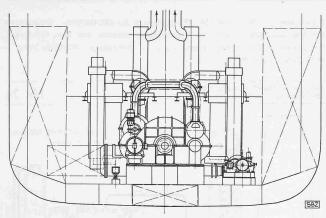
Abb. 28. Dampfturbinen-Anlage mit Veloxkessel für ein Frachtschiff von 5000 WPS-Leistung. a Kessel-, b Turbinen-Anlage, c Getriebe, d Helux-Stromerzeuger, e Hilfsgruppe, f Oelkühler
