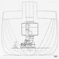
Abb 27. Verbrennungsturbinen-Anlage für ein Frachtschiff von 5000 WPS-Leistung. a Verdichter, b WA, c Brennkammer, d Gasturbine, e Getriebe, f Anwurfmotor, g Anwurfdiesel
