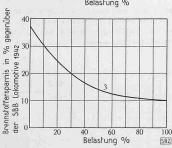
Abb. 26 (links). Spez. Brennstoffverbrauch (1) und Temperatur (2) vor der Gasturbine in Abhängigkeit von der Belastung einer Verbrennungs-Turbine für Lokomotiven von 2500 PS. Brennstoffersparnis (3) einer neuen Verbrennungsturbine von 2500 PS gegenüber der SBB-Lokomotive. (Durch verhältnismässig kleine Aenderungen kann diese Ersparnis schon heute erreicht werden)
