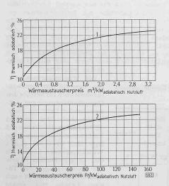
Abb. 21. Therm. Wirkungsgrad einer einstufigen Verbrennungsturb.-Anlage z. Winderzeugung in Abhängigkeit von der WA-Fläche (1) und vom WA-Preis pro kW adiabat. Nutzluftleistung. Für den WA wurde ein Vorkriegspreis von 40 Fr./m² eingesetzt
