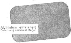
Dieses neueste und modernste Verfahren der anodischen Oxydation erzielt eine bedeutende Erhöhung der chemischen und mechanischen Widerstandskraft des Aluminiums.
