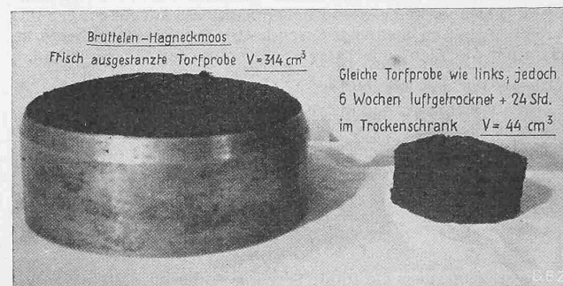
Abb. 23. Photo einer Torf-Schwindprobe
