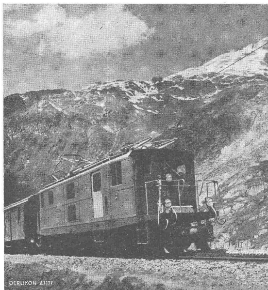
Lokomotive der Furka-Oberalp-Bahn für Adhäsions- und Zahnradbetrieb, mit elektrischer Ausrüstung Oerlikon.
