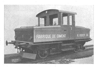
Akkumulatoren-Lokomotive mit elektrischer Ausrüstung Oerlikon
