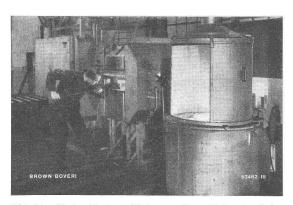
Härteöfen für hochlegierte Werkzeugstähle: Elektroden-Salzbadofen bis 13500 C (im Bild vorn) und Doppelkammerofen (hinten) mit metallischen Widerständen bis max. 1250 °C.
