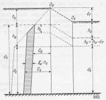
Abb. 10. Spannungsverlauf bei stark zusammendrückb. Material (für rechn. Setzungsanalyse)
