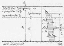
Abb. 11. Spannungsverlauf bei schwach zusammendrückbarem Material (für rechnerische Setzungsanalyse)
