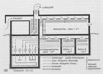
Abb. 9. Schematischer Aufriss der Kühlanlage (Längsschnitt)
