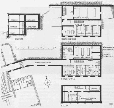
Abb. 2. Grundrisse und Schnitt der Forschungsstation Weissfluhjoch. — 1:400
